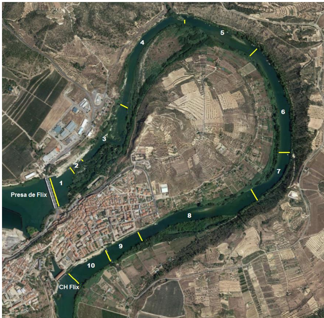
Figura 1. Imagen del meandro de Flix, entre la presa de Flix y la salida de la central hidroeléctrica del mismo nombre. En la misma imagen se muestran los 10 subtramos establecidos a lo largo del meandro para su caracterización hidromorfológica. Imagen obtenida de Google Earth®.
