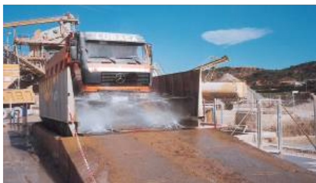
Ilustración 78: Sistema de lavado de ruedas y bajos del camión
